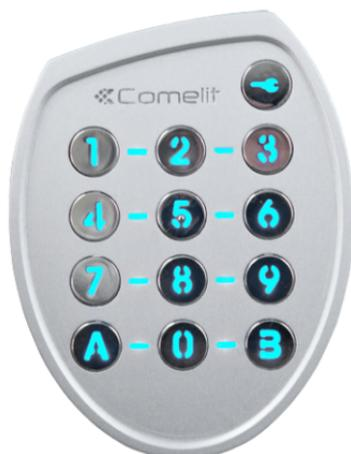
Clavier à codes en zamak, 100 codes de 3 à 6 caractères, touches rétroéclairées. Gestion par logiciel RESIPRO sur internet . Relais paramétrables en mode monostable de 1 à 99 secondes ou bistable . Gestion BP d'entrée, horloge et alarme. Gestion IP ou Wiegand. Possibilité de relais externe. Température -25° à +50° C, IP54, IK10. Dimensions 104x80x19 mm
